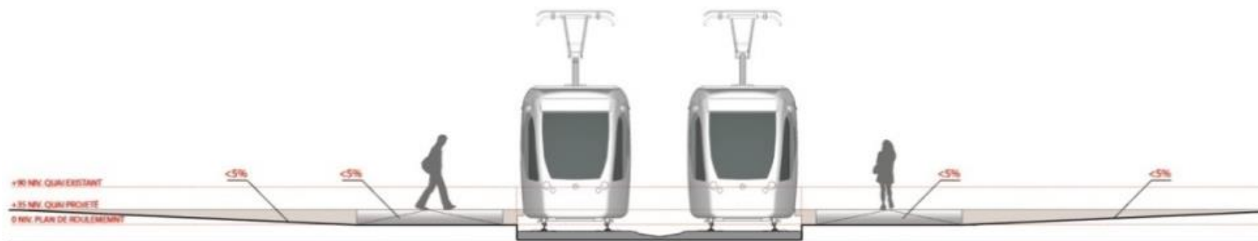
Figure 67 : Principe de nivellement des quais
